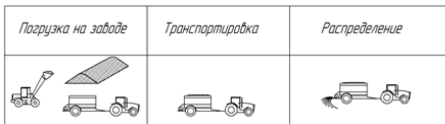
Рисунок 1. Прямоточная схема внесения дефеката
